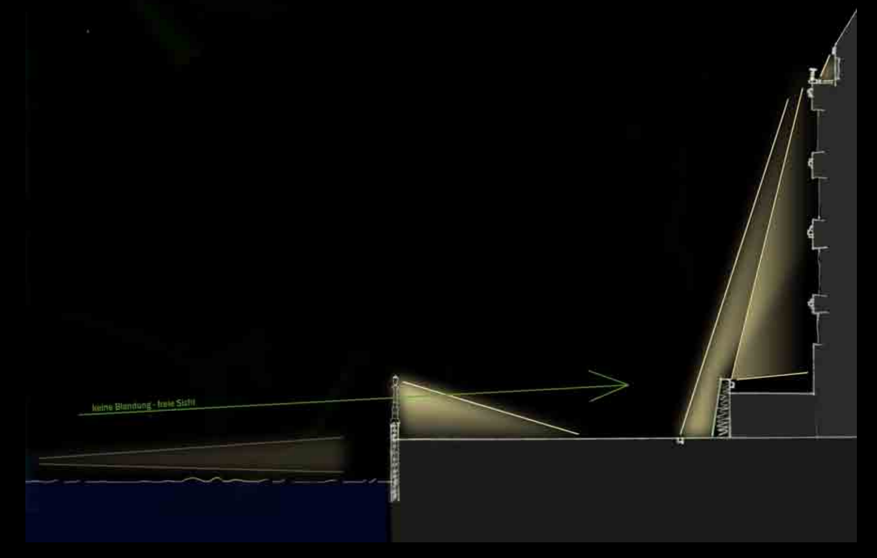
Lichtprinzipien: Kandelaber, Fassadenlicht; optionale Beleuchtung der Begrenzungsmauer durch Projektionstrahler
